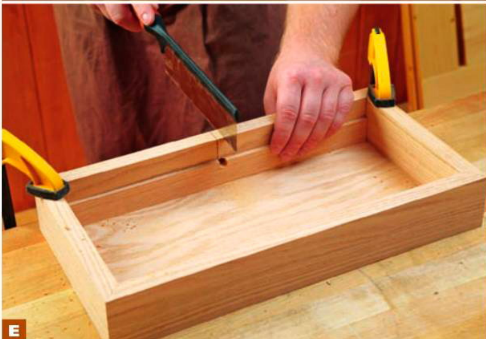
Для оптимального результата возьмите короткую обушковую пилу с мелкими зубьями (14-22 зуба на дюйм) и сделайте два вертикальных пропила.
