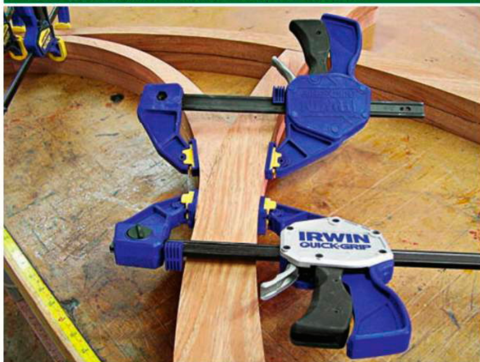
Накладки на губках Quick-Grip XR600 могут поворачиваться, что позволяет зажимать криволинейные и сужающиеся формы без дополнительных приспособлений.
