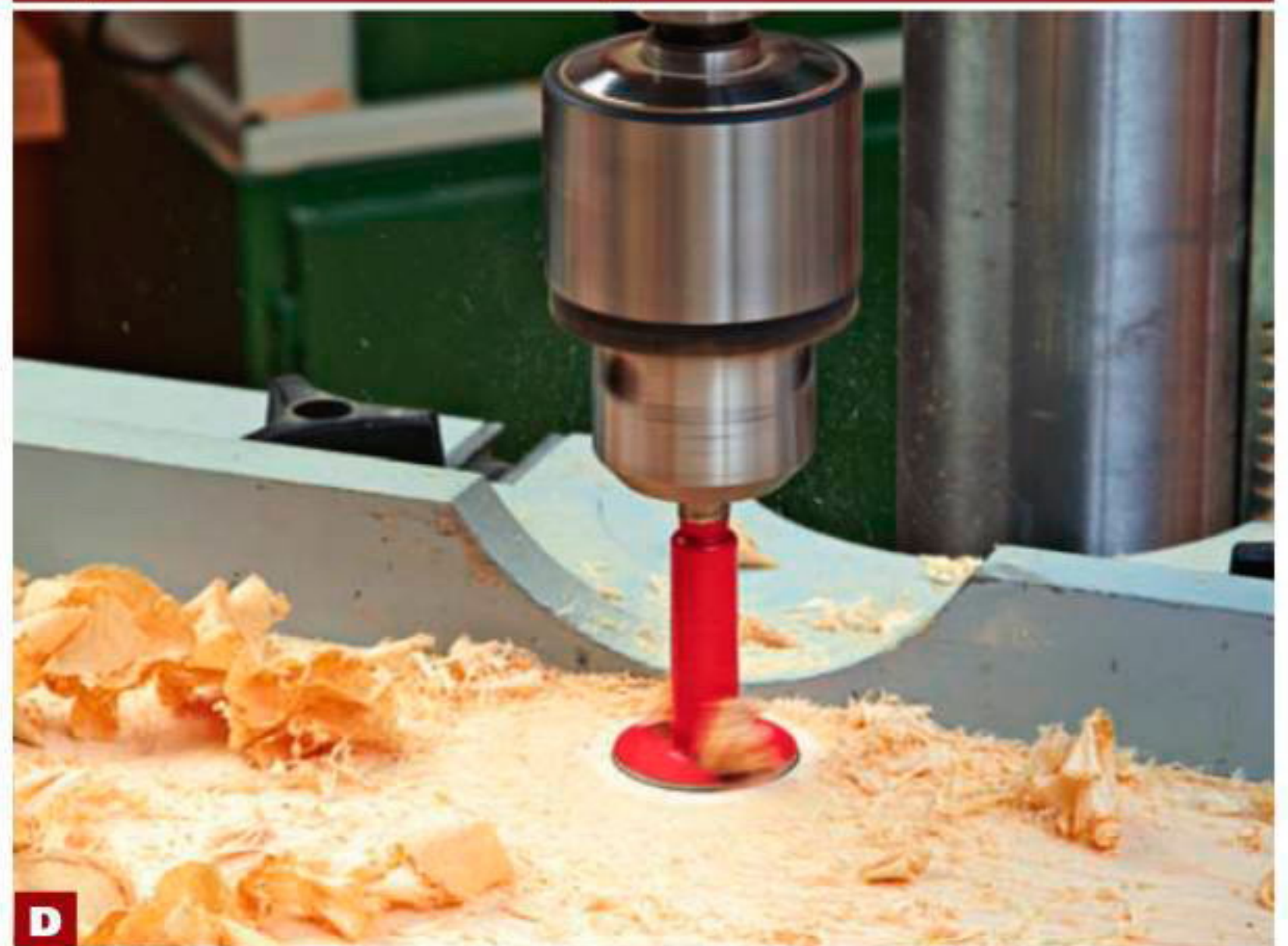
Д Сверло Форстнера диаметром 35 подходит почти для всех четырехшарнирных петель. Высверлите чашки глубиной 13 мм для чашек.
