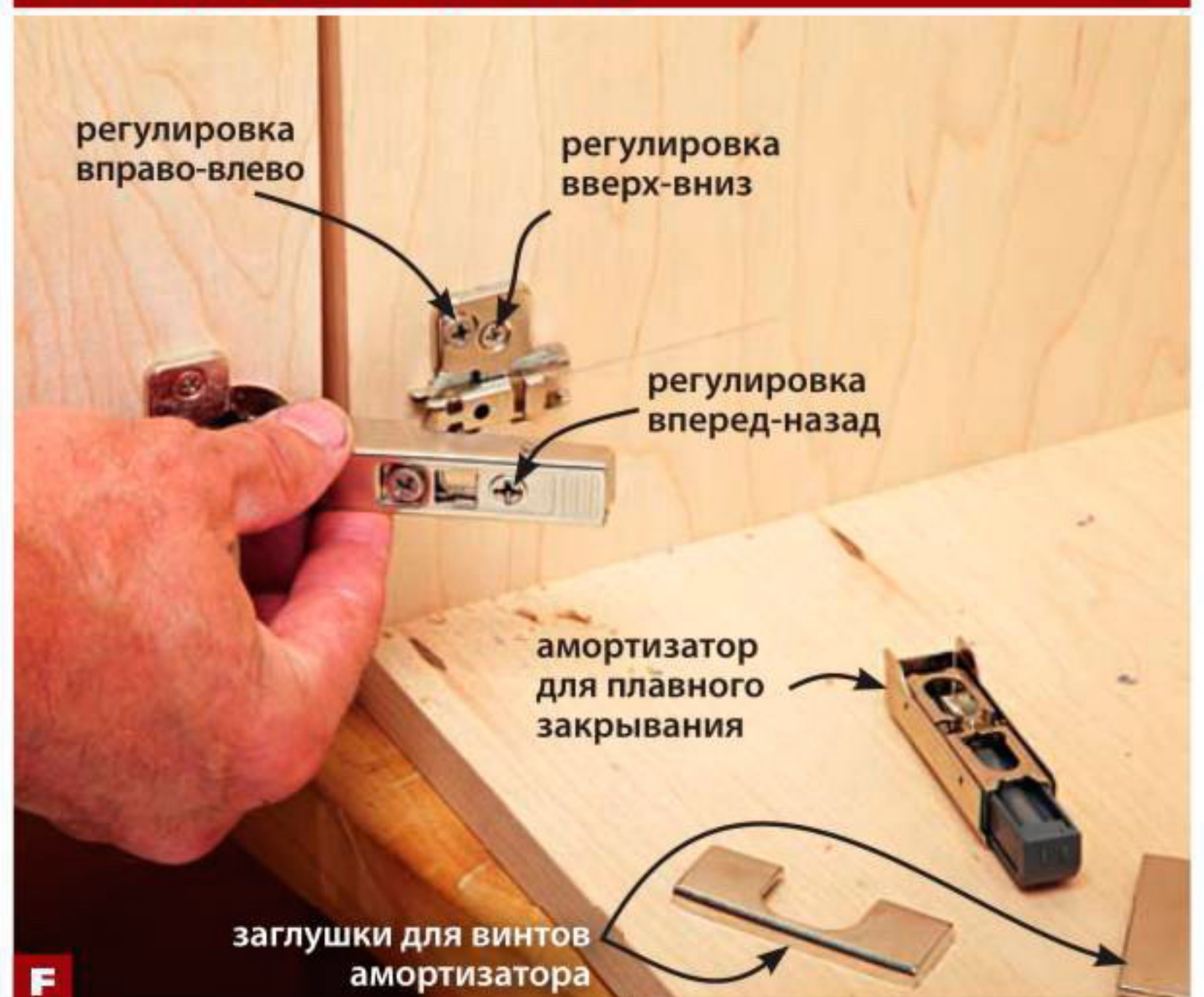
Ф Современные четырехшарнирные петли регулируются во всех направлениях. После установки дверцы точно отрегулируйте ее положение с помощью винтов.
