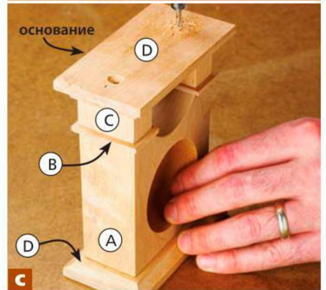
С Сделайте два раззенкованных монтажных отверстия диаметром 3,6 мм с направляющим отверстием 2,4 мм, проходящие сквозь основание D, колонны С и пластины В в корпус А.
