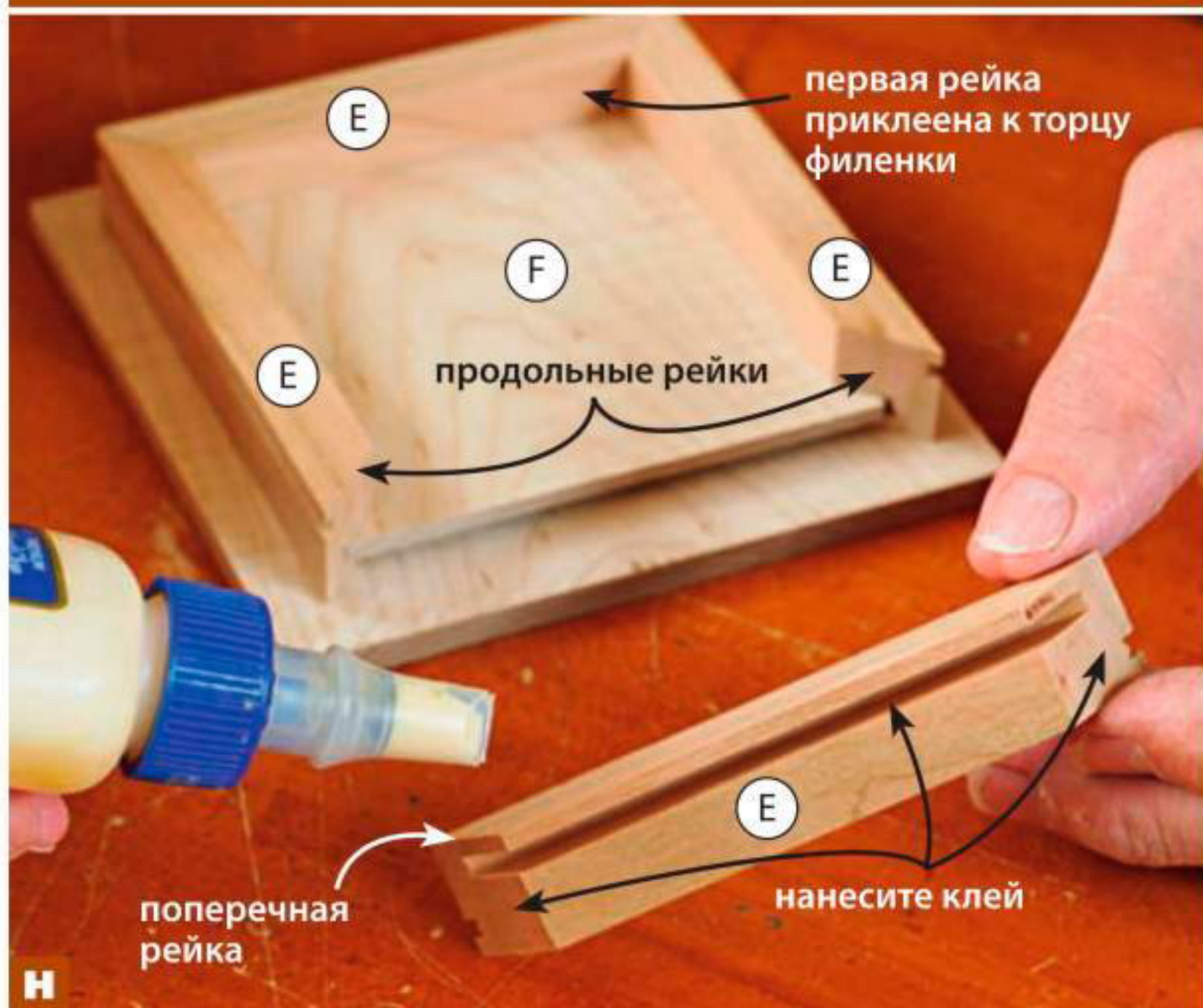
Равномерно нанесите клей на скосы и в середину шпунтов двух оставшихся реек E.
