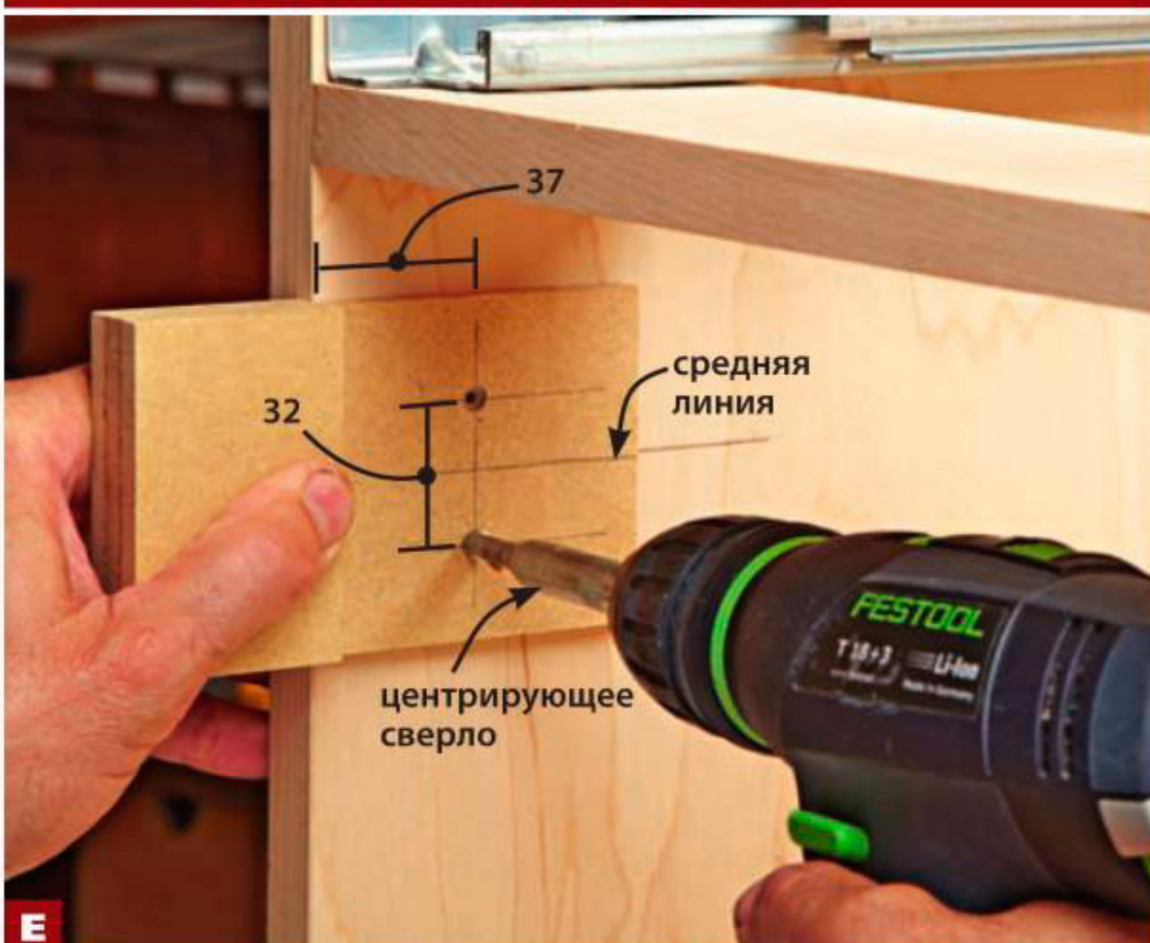
Е В инструкции к петлям обычно даются указания по разметке, но простое приспособление из нескольких обрезков 6-миллиметровой МДФ-плиты автоматически направляет сверло в нужную точку.
