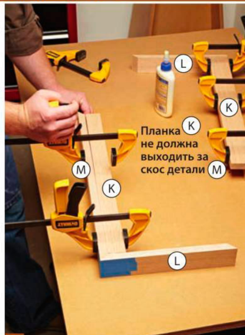
G Когда клей схватится, снимите струбцины и приклейте к каждой сборке L/M планки K, выровнивая по верхней стороне. Дайте клею высохнуть.
