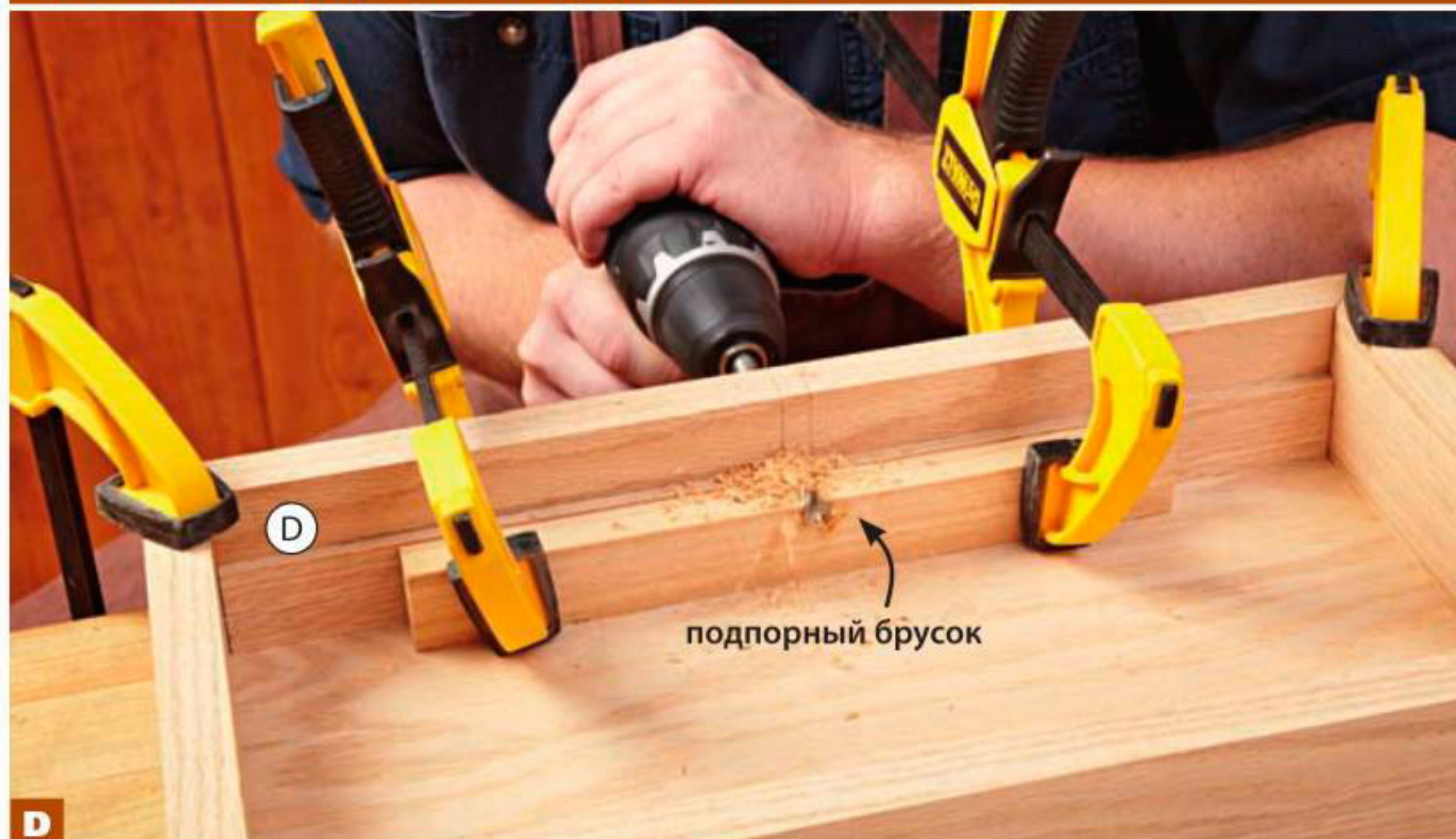
Перед тем как сверлить отверстие для прорези, прижмите струбцинами к опорной планке D подпорный брусок из обрезака.
