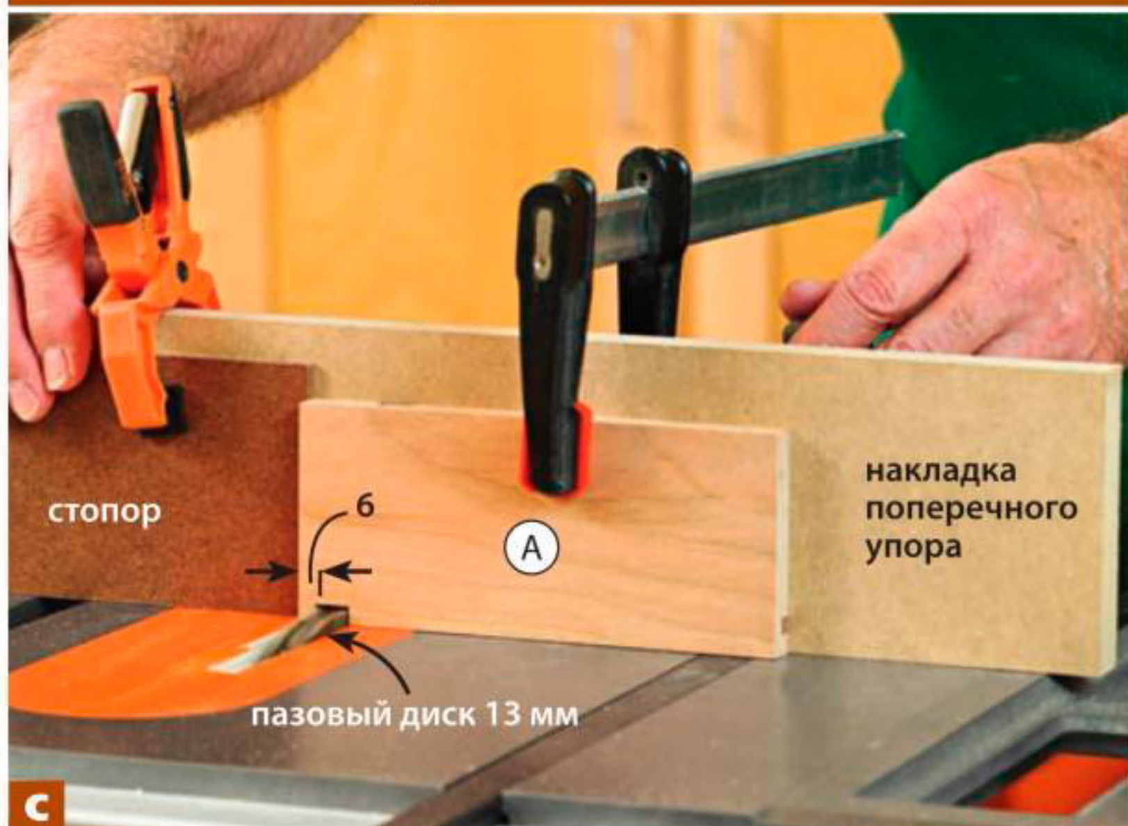
С Прикрепите к накладке поперечного упора стопор на расстоянии 6 мм от диска и сделайте в каждой стенке А вырез глубиной 6 мм.
