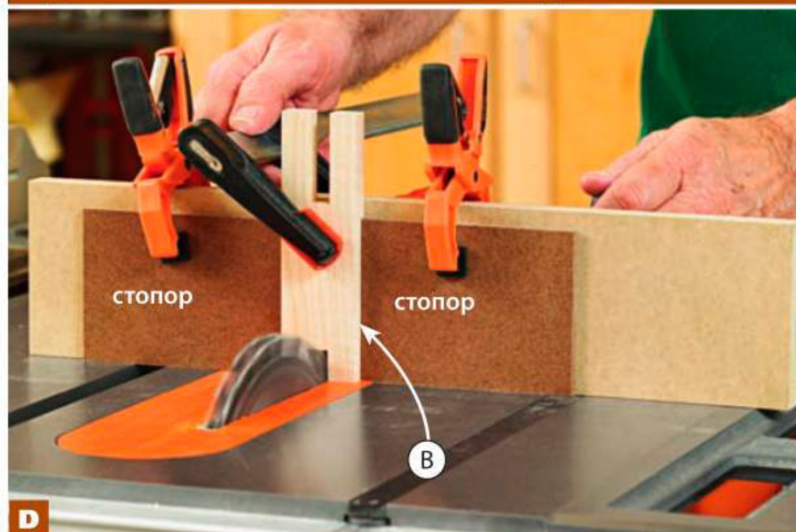
Д Выровняйте торец заготовки для ножек В по центру пазового диска и зафиксируйте ее положение двумя стопорами. Сделав вырез на одном конце, переверните заготовку и выпилите второй вырез.
