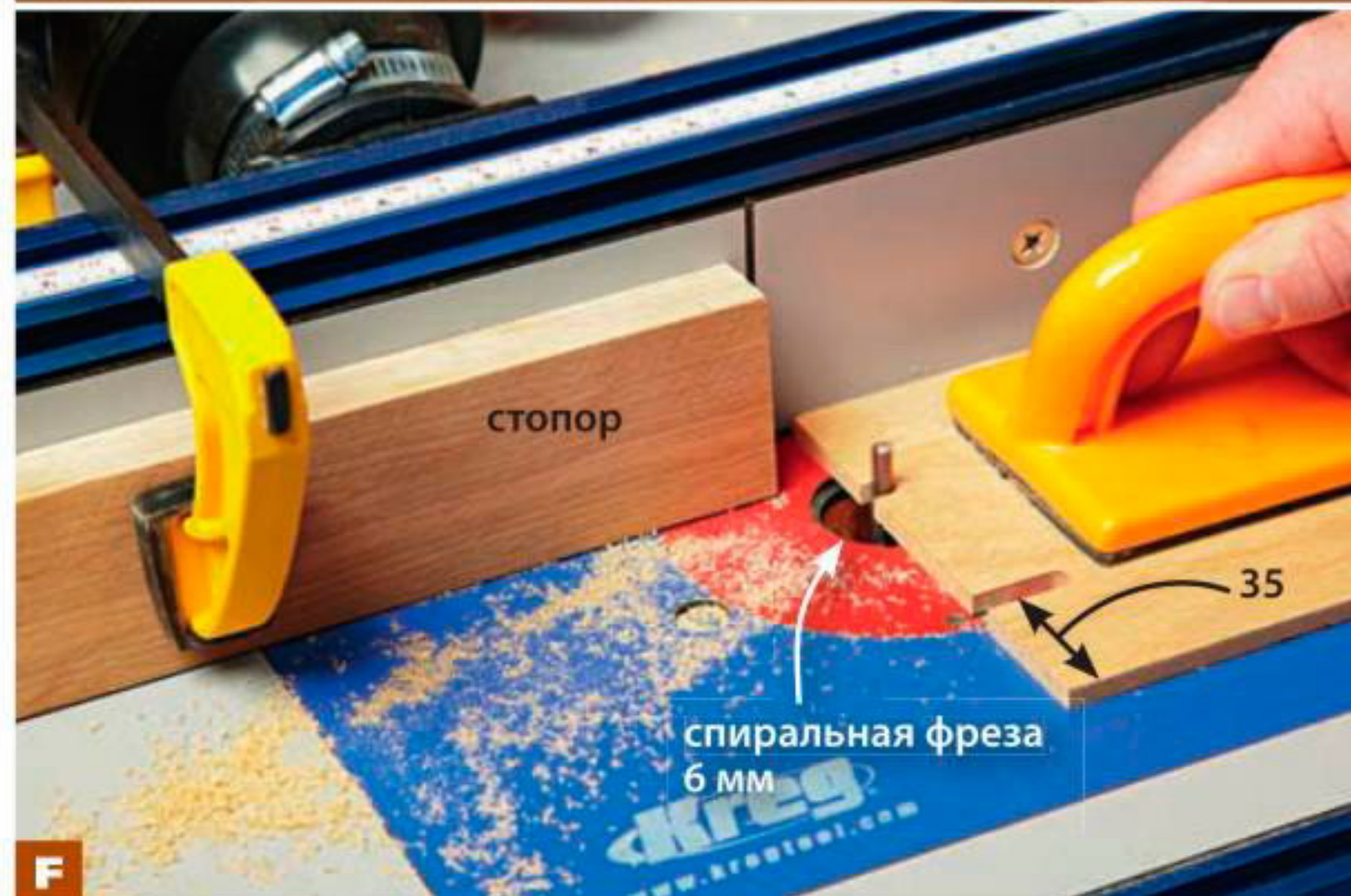
Располив продольный упор на расстоянии 35 мм от 6-миллиметровой спиральной фрезы (прямая 6-миллиметровая фреза тоже годится для этой задачи), закрепите на упоре стопор, чтобы получились прорези длиной 22 мм.
